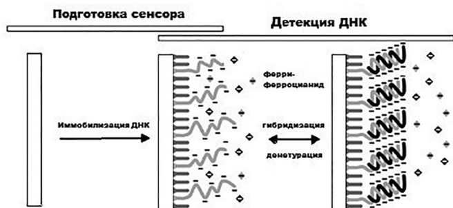
Рис. 2. Схема детекции процесса гибридизации ДНК с использованием окислительно-восстановительных меток
